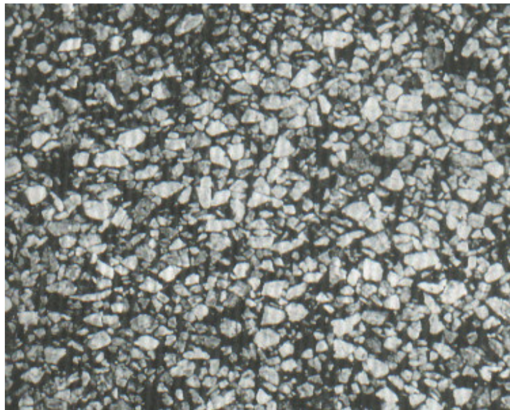
Figura A12. Pulimento de agregados.
