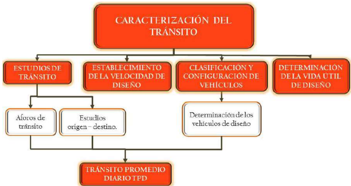
Figura 4.2 Esquema para la elección del tránsito de diseño
