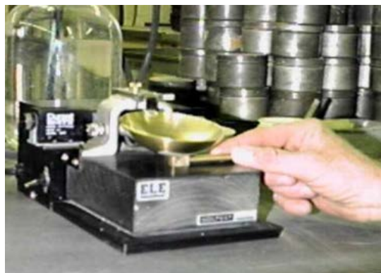
Figura 125 - 5. Ajuste de la altura de caída libre de la cazuela
