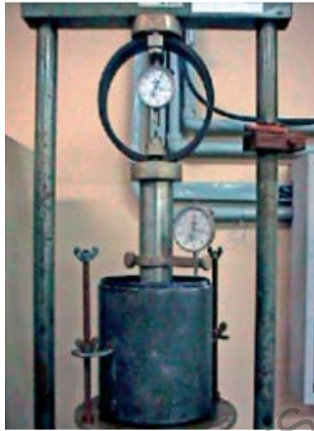
Figura 148 - 3. Ensayo de penetración
