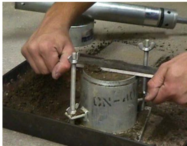
Figura 141 - 5. Enrase de la probeta
