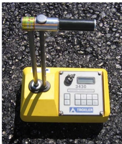
Figura 2. Densímetro nuclear Troxler 3430. Tomado de Mason & Williams (2009).
