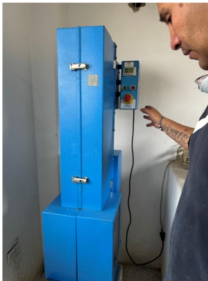
Figura 7. Compactación de muestra para hallar humedad óptima.
