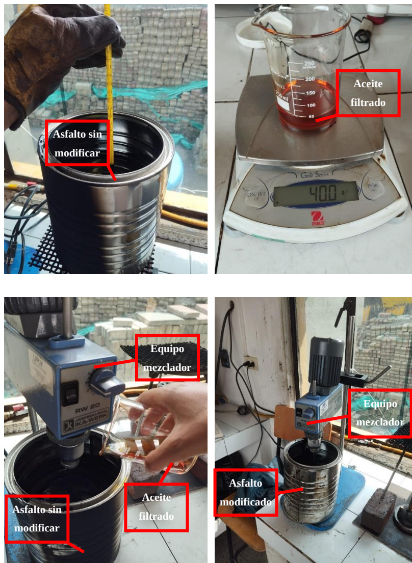
Figura 13 Proceso para modificar el asfalto adicionándole aceite de cocina reusado
