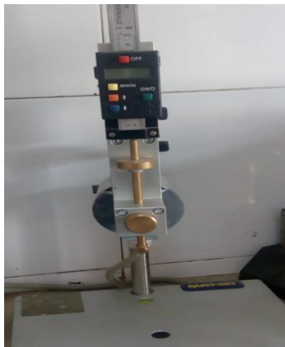
Figura 4 Equipo de penetración de materiales bituminosos
