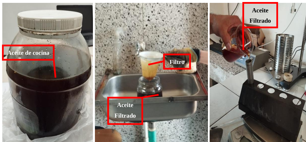
Figura 12 Proceso de filtrado del aceite de cocina
