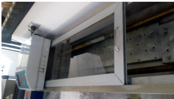
Figura 3 Ensayo de Ductilidad de materiales asfálticos
