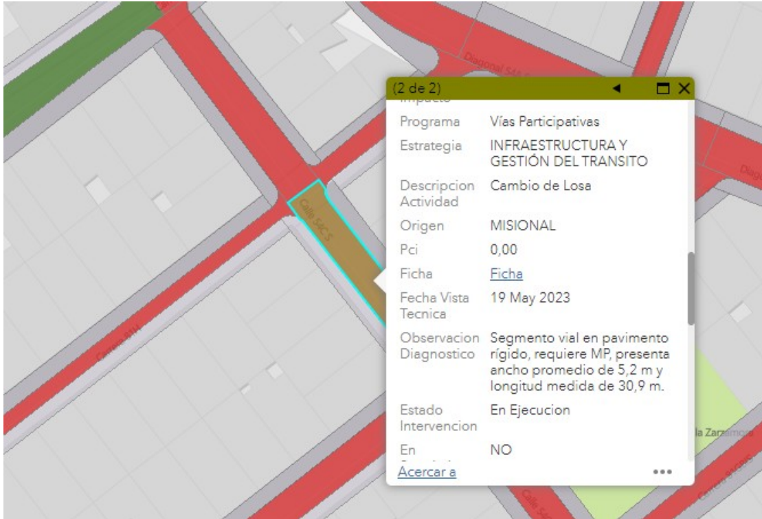
Imagen 01 “(...) Requiere actividades de cambio de losas y sello grietas. Estado terminado (...)” información Tomada del Sistema de Información Geográfica Misional y de Apoyo (SIGMA)
