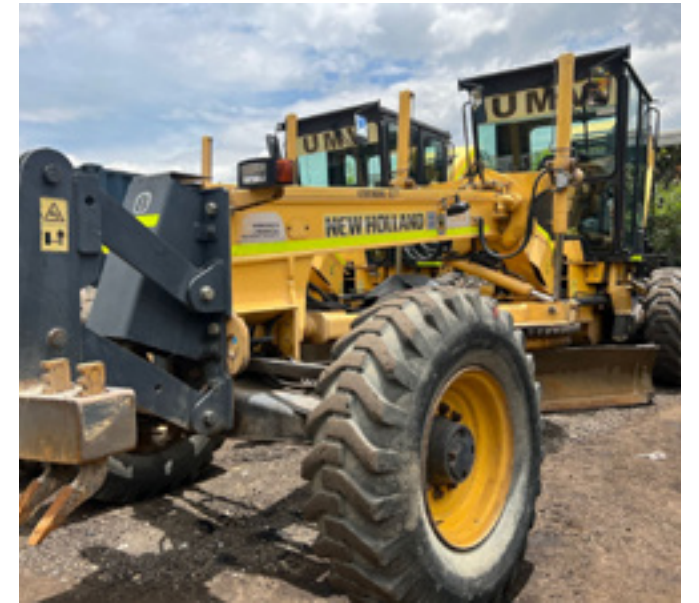
Foto 4: Motoniveladora a frentes de obra Fuente: UMV
