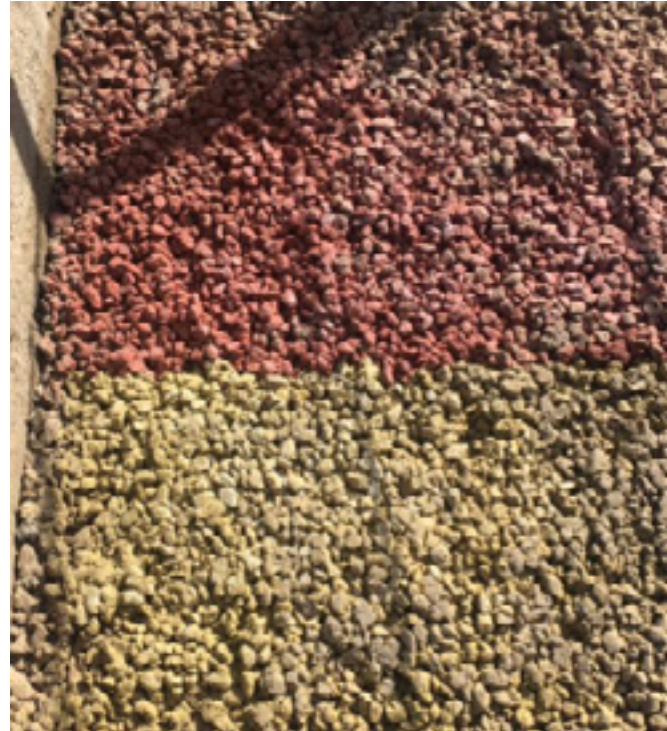
Foto 8: Concreto permeable en planta de la Elvira UMV Fuente: UMV
