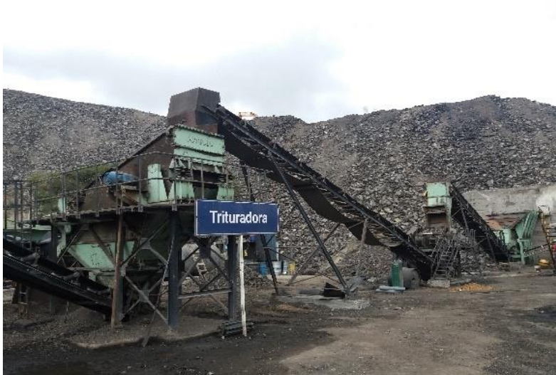
Figura 11 Planta de trituración de agregados UAERMV
