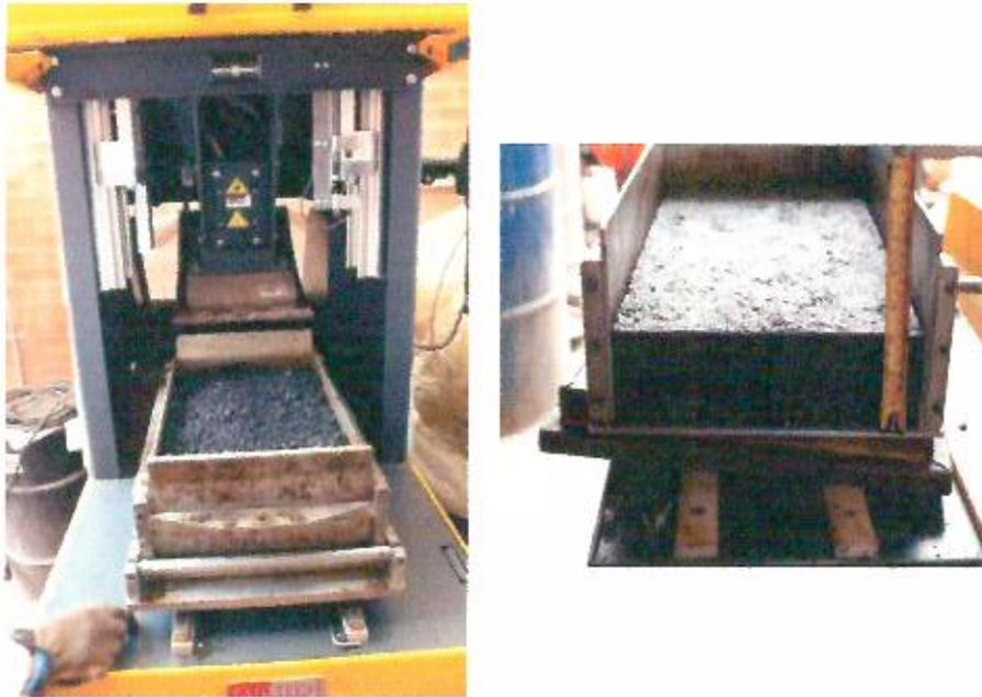
Figura 109. Proceso de fabricación de las probetas para los ensayos de deformación plástica en pista.
