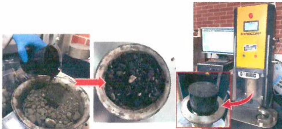
Figura 76. Fabricación de probetas en el compactador giratorio
