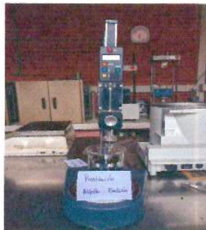
Figura 63. Ensayo de penetración al asfalto residual de la emulsión.
