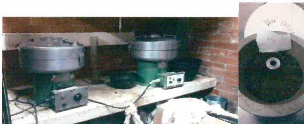
Figura 57. Equipo de centrifugas para extraer el asfalto.
