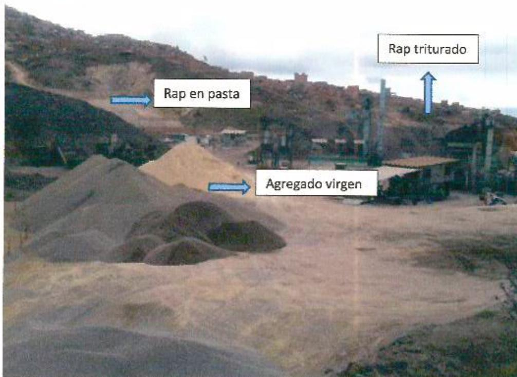
Figura 41. Fotografía global de la planta de la UAERMV en el Parque Minero Industrial "El Mochuelo". Zonas de almacenamiento de RAP y agregados vírgenes.
