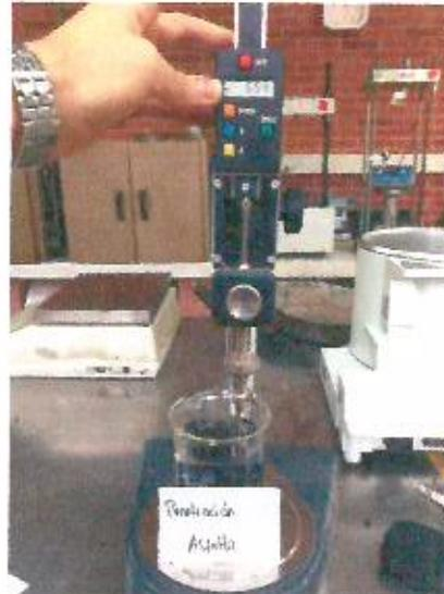
Figura 66. Ensayo de penetración al asfalto
