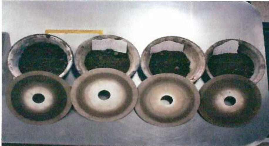
Figura 58. Agregados del RAP sin asfalto posterior al ensayo de centrifuga.
