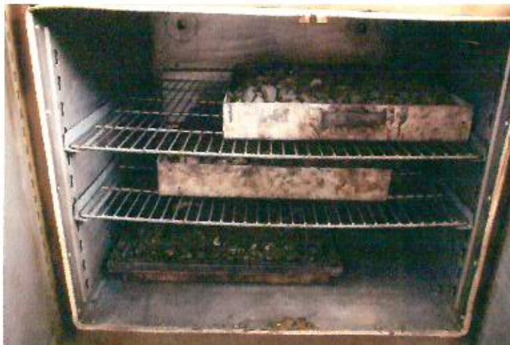
Figura 47. Material de RAP en el horno previo el proceso de tamizado.
