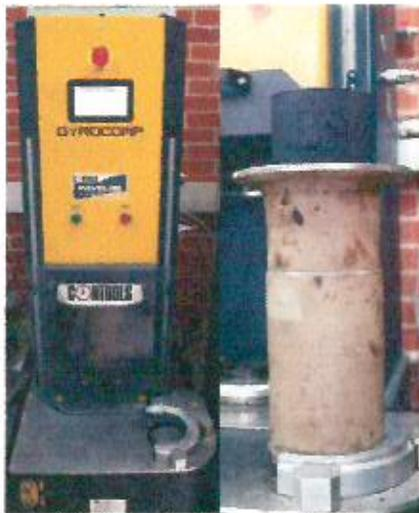
Figura 101. Fabricación de probetas mediante el compactador giratorio.
