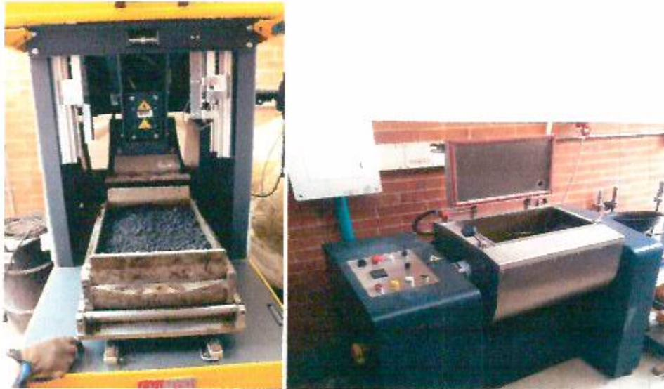
Figura 39. Equipo de compactación con rodillo y mezcladora.
