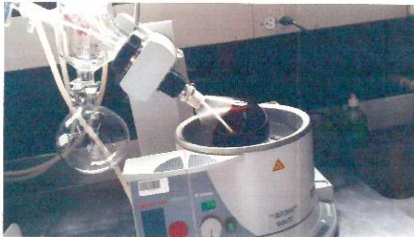
Figura 62. Equipo rotovapor para destilar el asfalto residual de la emulsión asfáltica
